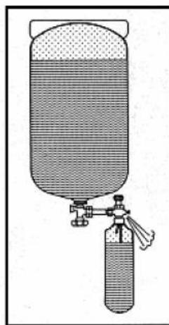
Flaschendrehgestell umdrehen. Flasche wird volumetrisch gefüllt
