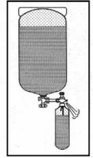
Flaschendrehgestell umdrehen. Flasche wird volumetrisch gefüllt
