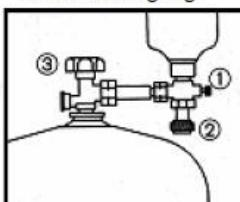
Vorratsflasche und Kleinstflasche mit dem Umfüllstutzen gasdicht verbinden
