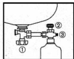
Bei Austritt flüssigen Propan aus der Entlüftung, Ventile in umgekehrter Reihenfolge schließen:
