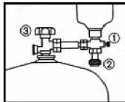
Vorratsflasche und Kleinstflasche mit dem Umfüllstutzen gasdicht verbinden
