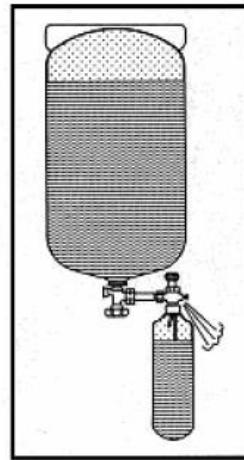
Flaschendrehgestell umdrehen. Flasche wird volumetrisch gefüllt
